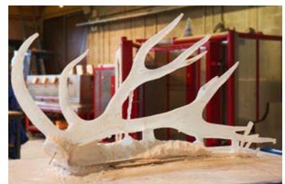
Sortie des moules du four après recuisson et démoulage délicat des pièces en verre. Photo : P. Robin
