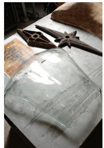
Modèle en plâtre des bustes : le verre plat est thermoformé à partir de cette matrice Photo : Paul Louis
