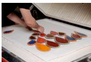
Plaques de verres fusionnés en forme de goutte, disposées dans le four de fusion
