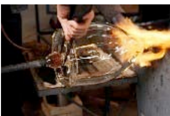
Réalisation d'un seau : formation d'un pontil : une seconde canne avec du verre est amenée sur le fond du seau se collant à lui, cela permet de libérer la première canne
