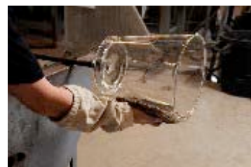
Réalisation d'un seau : le seau est finalisé. Il sera détaché de la canne et placé dans l'arche de recuisson
