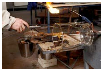
Réalisation d'un seau : la première canne détachée, l'ouverture du seau est modelée
