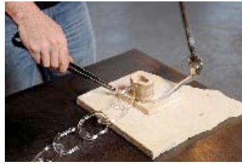
Réalisation d'un maillon de chaîne : enroulage autour d'un moule en plâtre
